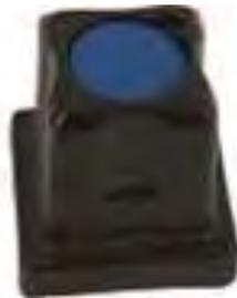
Квадратный наконечник – это переходной элемент из ВЧШГ с универсальной верхней частью, который одевается на шток задвижки для управления Т-образным ключом 30X30.
